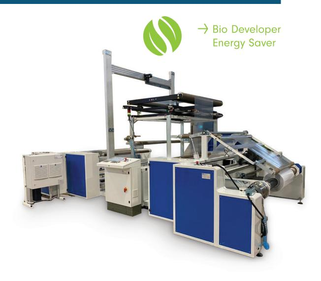
La **Doctor Machine** è un sistema di svolgitore avvolgitore ad alte prestazioni, studiata e realizzata in collaborazione con affermate aziende nel settore packaging alimentare e medicale con la necessità di controllare la qualità della bobina post estrusione, e renderla conforme all'utlizzo.
