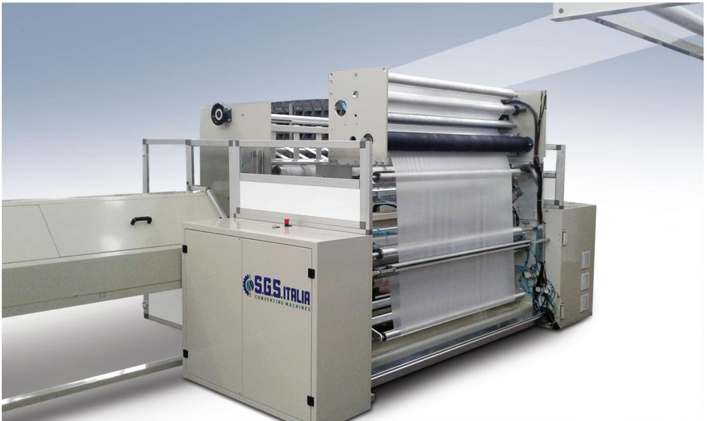
Il **Windroll** è un avvolgitore automatico a due stazioni, senza l'utilizzo di scotch o altri sistemi di incollaggio per la partenza di avvolgitura del film sul cartone, completo di magazzino anime di cartone automatico e carico e scarico del prodotto finito. È possibile avvolgere sia foglia che tubolare con diametro della bobina finita da un minimo di 150 mm ad un massimo di 400 mm, e a richiesta la possibilità di avvolgere anche a metraggio.
